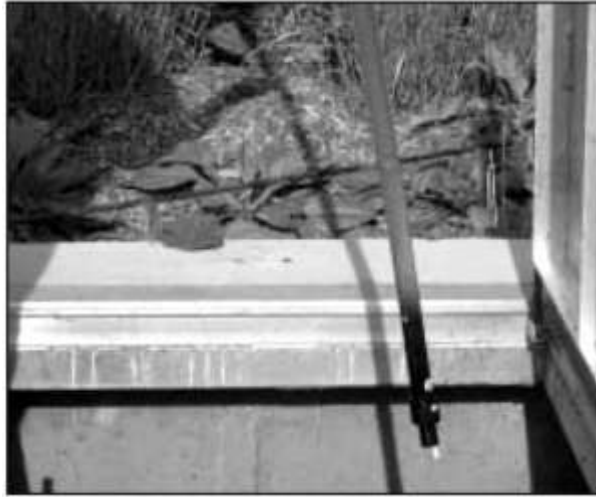
شکل ۵- دستگاه لجن‌سنج هنگام برداشت نمونه جامدات زیستی
